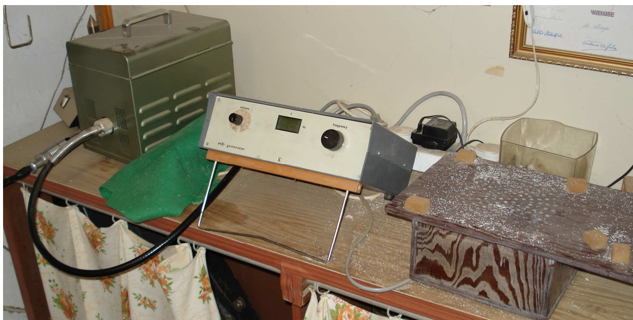
Obr. 17 Generátor sinusového vlnění zvuku (vlevo), ovládací zařízení z jehož displeje lze odečítat hodnoty frekvence vlnění (uprostřed) a reproduktor (vpravo).
