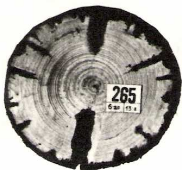
Obr. 9. Těžko propustná běl smrku (83, 265) normálně sušeného. Propustná běl smrku (87, 266) po ošetření vodou.
