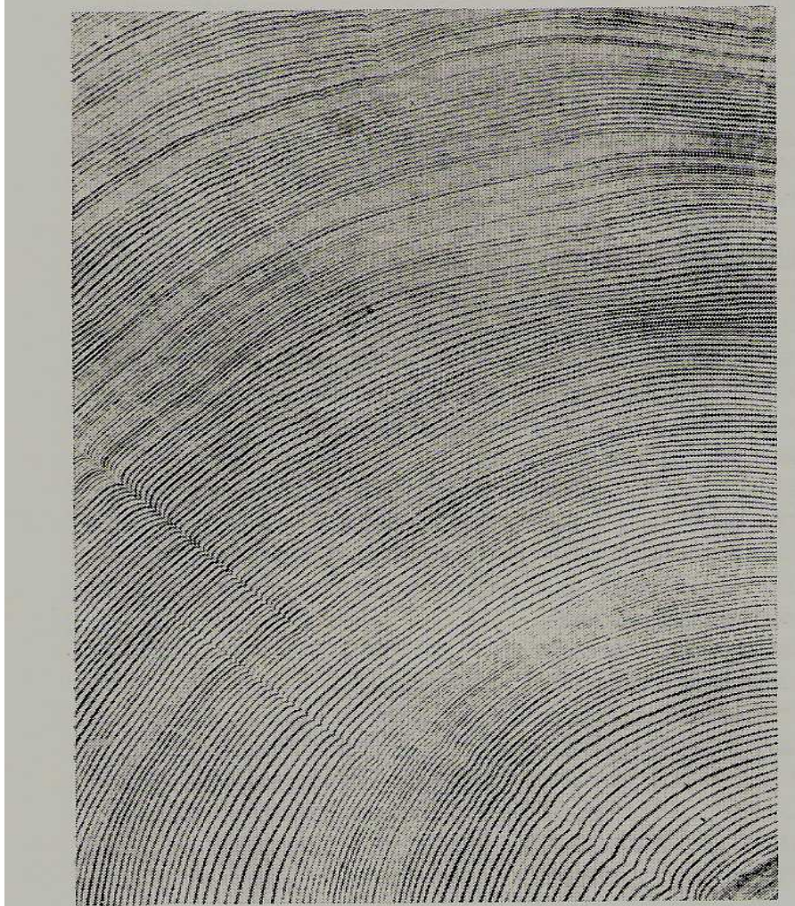
Obr. 2 Příčný průřez rezonančním dřevem s jemnými letokruhy a malým podílem letního dřeva v celém průřezu.
